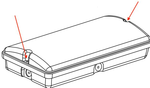
2. 2x Schrauben der Lichtplatte lösen und vorsichtig die Lichtplatte umklappen.
