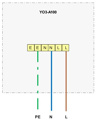
Aktivierung durch schalten der Phase L durch Schliesserkontakt
